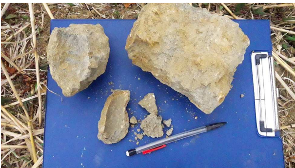
Sol : molasse compacte gris-beige (faciès marneux) Puits de reconnaissance P1 entre 1.6 et 2.4 m/TN
