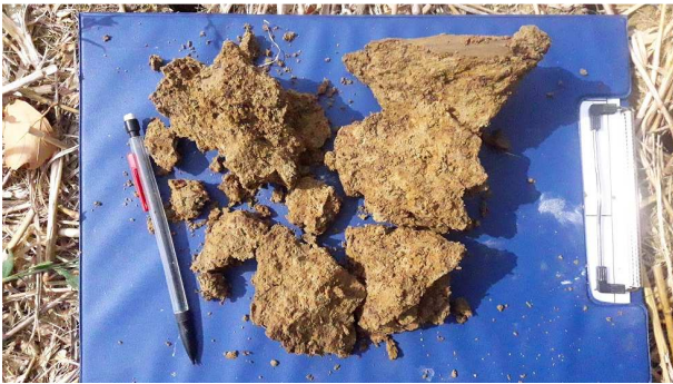
Sol : colluvions : limon +/- argilo-sableux marron bariolé beige/ocre Puits de reconnaissance P3 entre 0.8 et 3.0 m/TN
