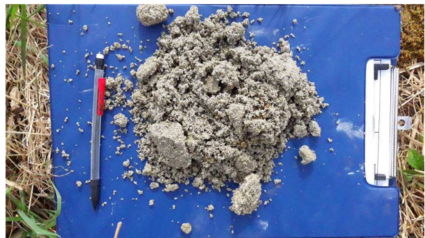
Sol : molasse grise (faciès sablo-argileux) Puits de reconnaissance P5 entre 2.0 et 3.1 m/TN
