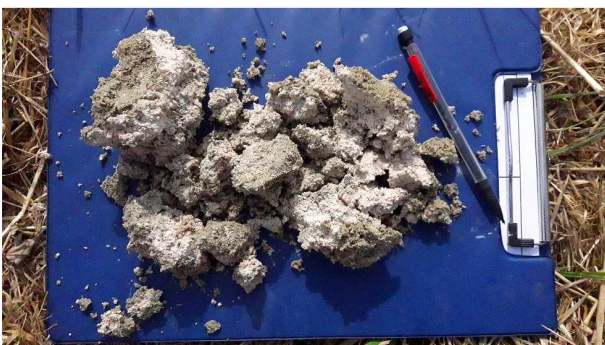
Sol : niveau argilo-calcaire blanchâtre observé localement dans la molasse sableuse Puits de reconnaissance P5 entre 1.4 et 2.0 m/TN
