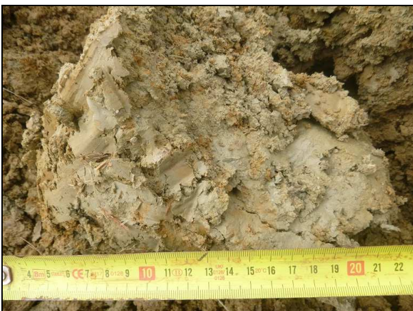
puits P4 : argile beige plastique (colluvions) prélevée entre 0,3 et 2,6 m.
