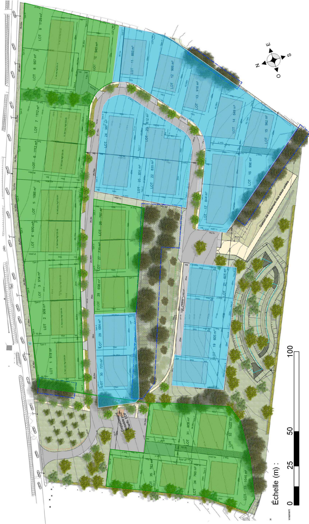
Interprétation géotechnique - Zonage du lotissement
