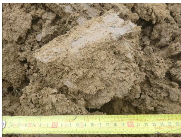
Sol : argile sableuse beige (colluvions) puits P1 : sol prélevé entre 0,3 et 2,5 m
