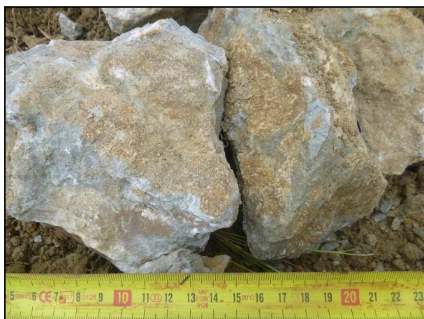
Sol : sable beige à gris +/- grésifié par un ciment calcaire (molasse) puits P1 : faciès calcaro-gréseux prélevé dès 0,3 m
