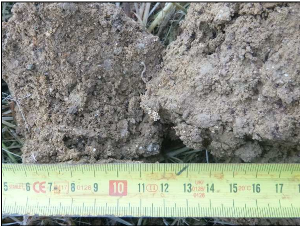
Sol : sable beige à gris +/- grésifié par un ciment calcaire (molasse) puits P3 : faciès sablo-argileux prélevé entre 1,9 et 2,4 m
