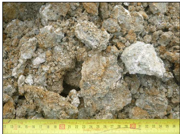
puits P5 : faciès grésocalcaire (molasse altérée) prélevée entre 0,3 et 2,0 m.
