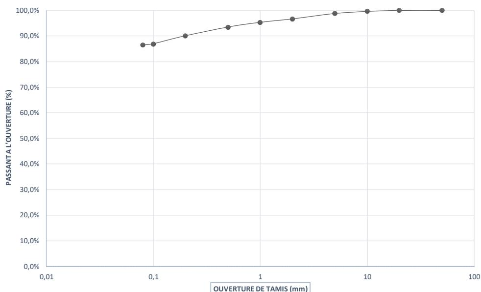
D MAX (mm) **20**fraction 0/2mm dans la fraction 0/50mm **96,7%**fraction 0/80µ dans la fraction 0/50mm **86,4%****Teneur en eau pondérale de l'échantillon**
