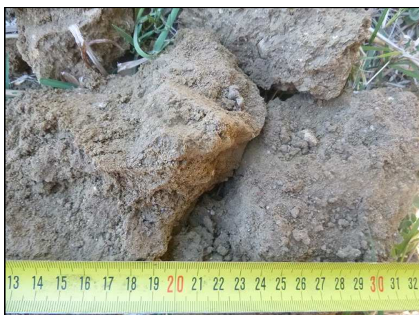
Sol : colluvions argilo-sableuses à cailloutis Puits P1 sol prélevé entre 0,3 et 2,5 m.
