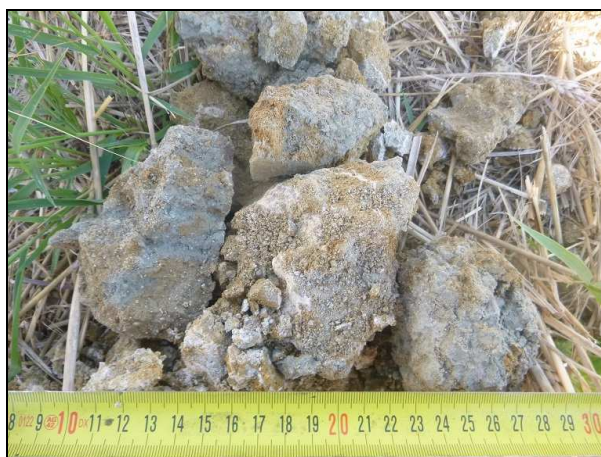
Sol : molasse sablo-argileuse grésifiée bariolée Sol prélevé dans le puits P3
