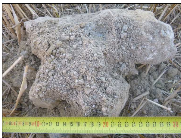
Sol : molasse sablo-argileuse +/- grésifiée Puits P2 : sol prélevé entre 0,3 et 1,4 m.
