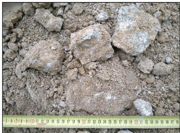
puits P4 : argile calcaire prélevée entre 1,8 et 2,8 m
