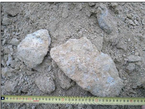
puits P5 : sable argileux grésifié prélevé entre 0,6 et 2,0 m.
