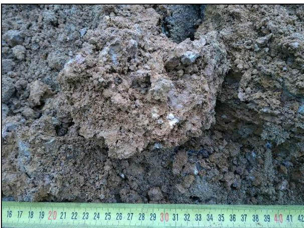
puits P3 : argile sableuse prélevée entre 2,6 et 2,8 m.
