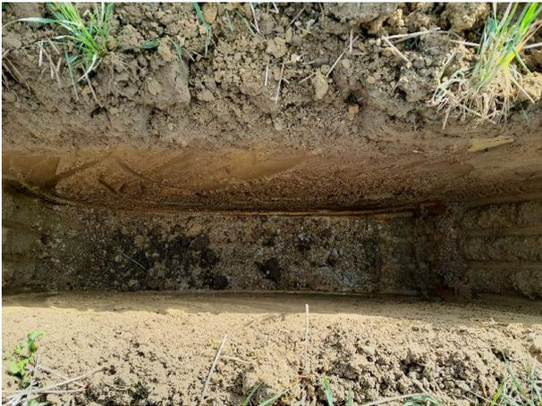
Fouille à la pelle pour essais d'infiltration (Kv1)
