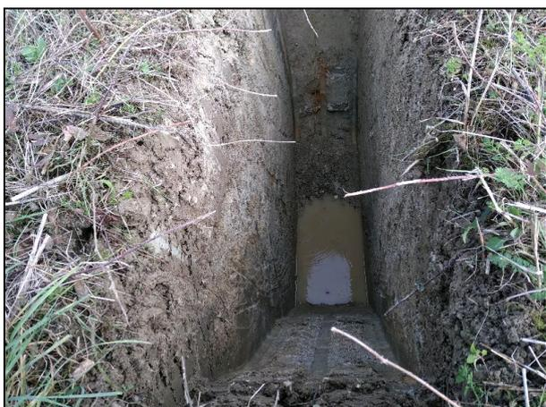
essai de perméabilité à charge variable
