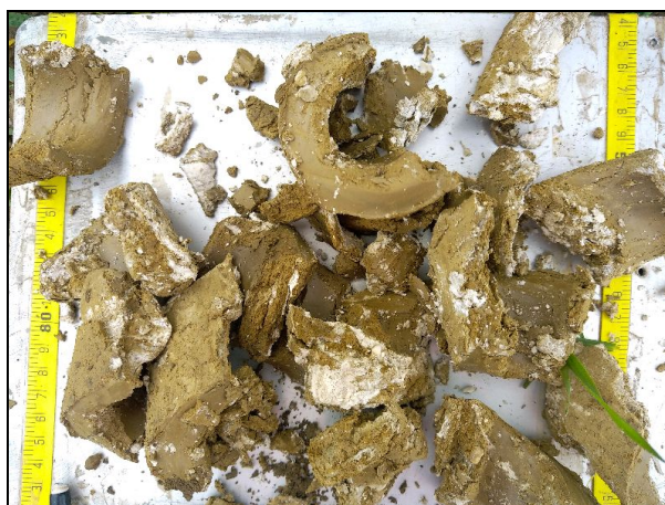
Sol : marnes +/- sableuses beige sol prélevé en T1 de -1,4 à -2,2m/TN
